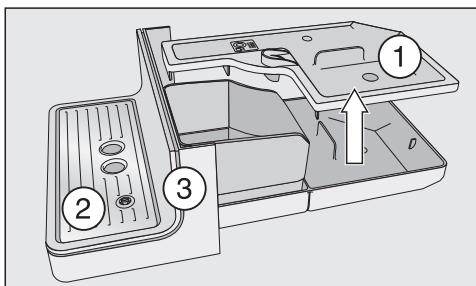
■ Осторожно выньте поддон для жидкости из кофемашины. Снимите крышку ①.
