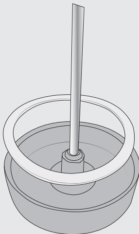
При необходимости вы можете снять соединительный элемент и уплотнительное кольцо с крышки ёмкости для молока. Если вы хотите снять трубку из нержавеющей стали, то слегка выдавите соединительный элемент из внутренней части крышки. Вымойте отдельные детали в посудомоечной машине.
