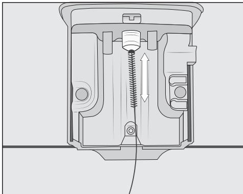
Протолкните щёточку для очистки в паровую форсунку максимум на 1 см.
