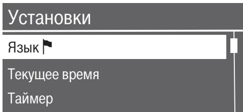
Расположенная справа черта на дисплее указывает на то, что следуют другие опции или другой текст. С помощью кнопок со стрелками ^ V Вы можете вызвать их отображение.
