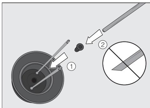
Следите за тем, чтобы **не** вставить скосенный конец стальной трубы в уплотнение. Уплотнение из-за этого повреждается.
