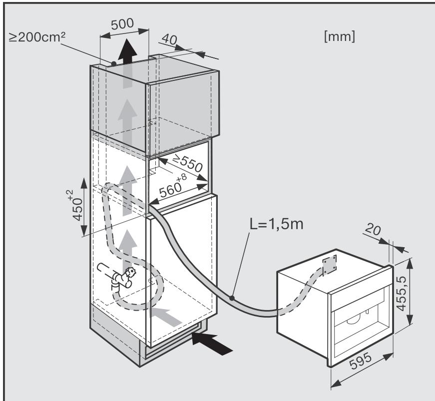
Комбинация с другой встраиваемой техникой Miele возможна. При этом, однако, очень важно, чтобы прибор был отделен снизу закрытым промежуточным дном (кроме комбинации со встраиваемым подогревателем посуды/пищи).
