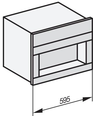
Комбинация с другой встраиваемой техникой Miele возможна. При этом кофемашина должна быть отделена снизу цельной промежуточной полкой. При комбинации со встраиваемым подогревателем посуды/пищи нет необходимости в наличии промежуточной полки.
