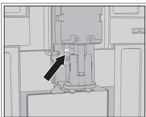
Соединительный элемент трубы подачи молока вынимать не нужно. При необходимости очистите соединительный элемент щёточкой для чистки.
